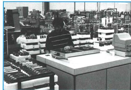
En fin de test les informations de défaut sont imprimées sur un "ticket de faute" indiquant (aussi précisément que possible) le composant mesuré en défaut.
