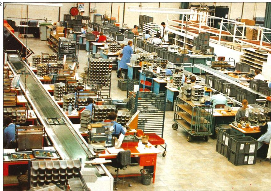
Plantons le décor : en amont, un magasin de pièces élémentaires (8000 références), puis les sections de bobinage, d'insertion de composants sur des circuits imprimés, de soudure et de test.
