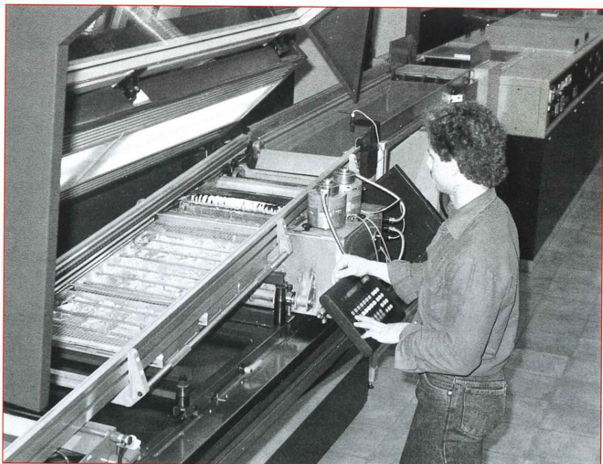
Le point clé dans la qualité de réalisation d'assemblage d'une carte en circuit imprimé est l'opération de brasage (soudage). Cette opération est désormais confiée (sur proposition de la section productive de l'usine) à un ensemble très moderne de soudage nettoyage, mis au point par la Société française O.S.L.
